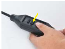
2. Press the «RESET» button, the indicator light turns red.
