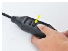
4. Appuyez de nouveau sur le bouton «RESET»; le voyant s'allume.
