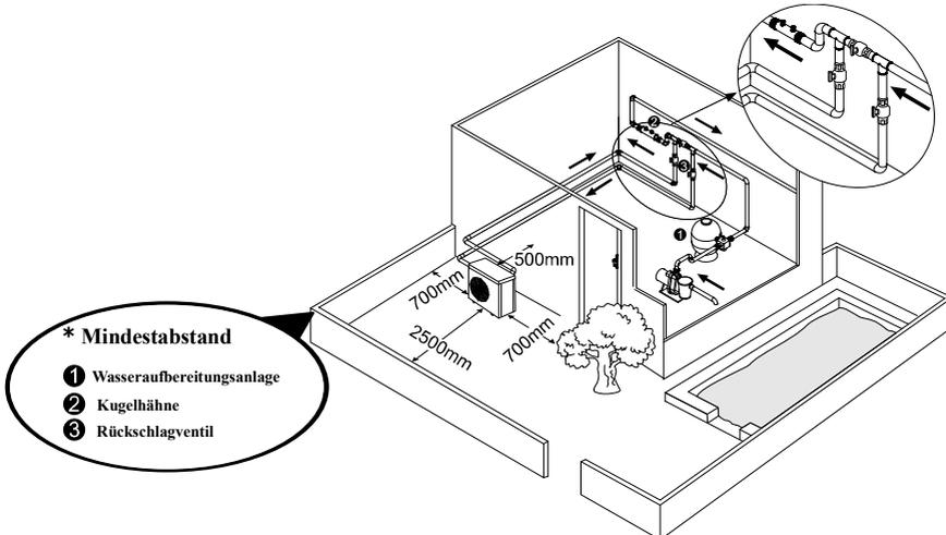
2) Der Rahmen ist mit Schrauben (M10) an einem Betonfundament oder an Trägern oder Halterungen zu befestigen. Das Betonfundament muss stabil und fest montiert sein; die Träger oder Halterungen müssen entsprechend stabil und tragfähig und korrosionsgeschützt sein.
