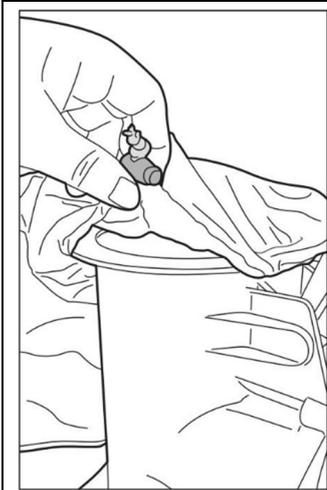
Spreid de filterzak over de bovenste opening van de hoofdbehuizing van de zwembadstofzuiger. Zorg ervoor dat het koord van de zak onder de flens van de bovenste opening is geplaatst.
