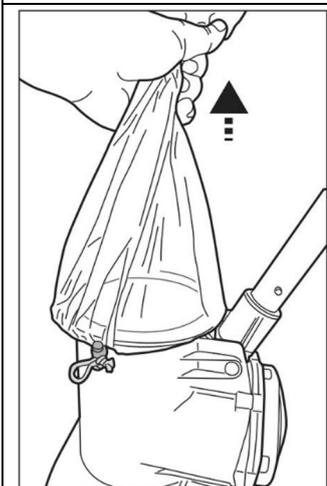
Til de zak op om ervoor te zorgen dat deze volledig is beveiligd voordat u de zwembadstofzuiger in water plaatst.
