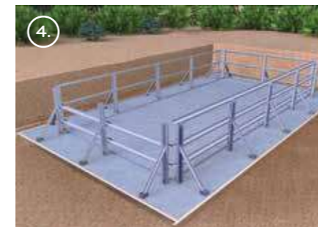
4. Plaatsing van de panelen (vastklikken + rivetteren)
