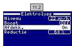
11.2 Reductie van de chloorproductie bij gesloten afdekking van het zwembad. Wanneer het zwembad afgedekt is, hoeft het systeem niet op volle kracht te werken. Met deze instelling kunt u de chloorproductie optimaal regelen.
