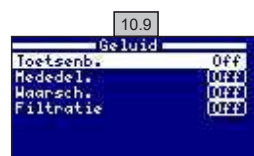
10.9 Geluid: Programmering van het systeem dat geluiden voortbrengt voor de volgende functies: Toetsenb. (toetsen), Mededel. (urgente berichten), Waarschu. (alarm), Filtratie (start filtratie).
