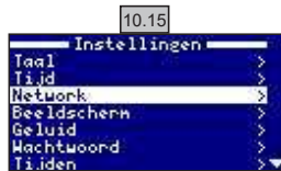
10.15 WiFi Network: Nadat de WiFi-module is aangesloten, start u uw apparaat opnieuw. De optie Network verschijnt dan in het menu Instellingen.
