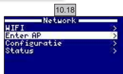
10.18 Selectie van het toegangspunt: Voer handmatig de naam en het wachtwoord van het geselecteerde netwerk in.
