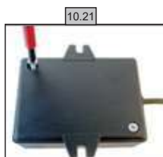
10.21 Verwijder het onderstel van de WiFi-module.
