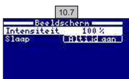
10.7 Instelling van de intensiteit van de schermverlichting (0-100 %) en programmering van de in-/uitschakeling van het beeldscherm.
