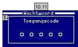
10.11 Wachtwoord: Hiermee kunt u de toegang tot het gebruikersmenu met een wachtwoord beveiligen. Om uw wachtwoord in te voeren, drukt u op een combinatie van 5 toetsen. Deze combinatie wordt door het systeem opgeslagen. Er is ook een "hoofdwachtwoord" voor het geval dat u uw wachtwoord bent vergeten. Neem contact op met uw installateur/leverancier.
