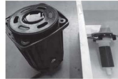
2. Pumpengehäuse 45° drehen im Gegenuhrzeigersinn (links) (nur DM30000S)
