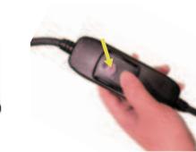
4. Appuyez de nouveau sur le bouton «RESET» ; le voyant s'allume. La protection différentielle fonctionne correctement.
