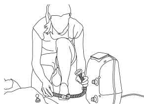
2) Sortez le bloc moteur et le tuyau de gonflage et positionnez-les à proximité de la structure gonflable.
