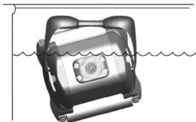
Verkeerde hoogte van de waterlijn
