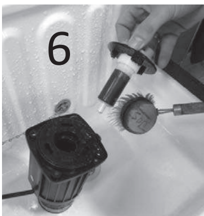
Rotor met water en borstel schoonmaken
