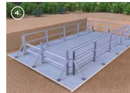
4. Plaatsing van de panelen (vastklikken + rivetteren)
